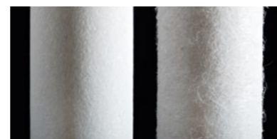
Слева: полипропиленовый картридж Prio®. Справа: типичный импортный полипропиленовый картридж (Китай), распространенный на рынке.
